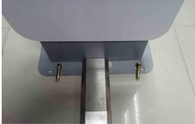
底部座架由四颗 M8\*60mm 膨胀螺钉固定,起到稳固作用(可调节)
